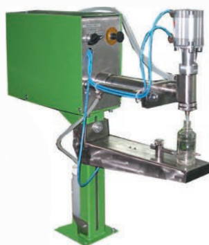
Batchers PRK.02, PRK.03 Дозаторы ПРК.02, ПРК.03
